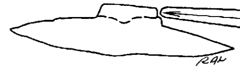
7.42. Удаление выступа отжимником или панчем
